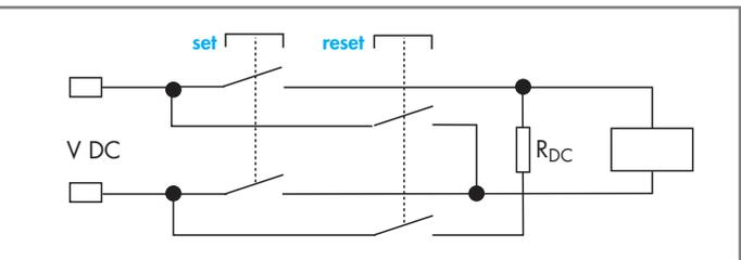
Pulsando SET, el relé se magnetiza a través de un diodo, los contactos pasan a la posición de trabajo y permanecen en ella.
