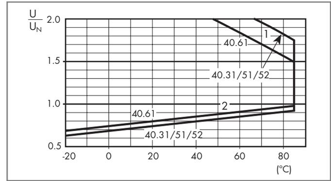
**R 40 - Campo de funcionamiento de la bobina DC en función de la temperatura ambiente**
