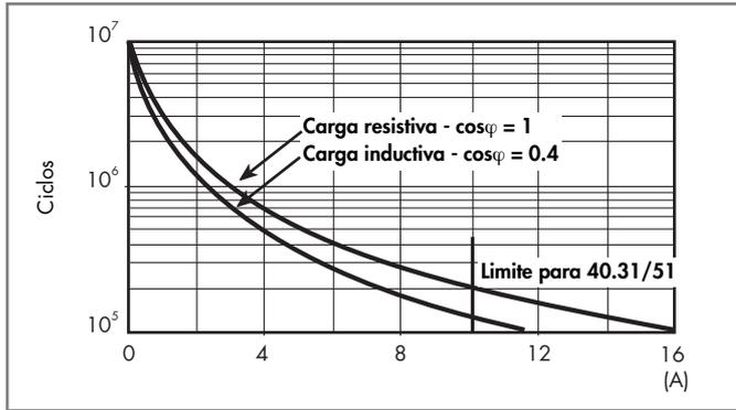
**F 40 - Vida útil eléctrica (AC) en función de la carga**
